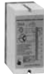
Groupeur. Permet de commander simultanément jusqu'à 4 stores avec interrupteur. Montage en applique. Alimentation: 220/240V - 50 Hz. Dimensions: 160 x 110 x 50 mm.
